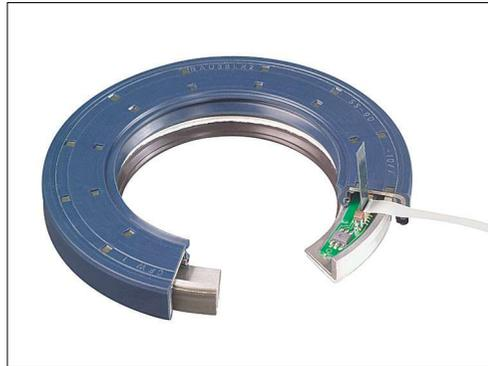
Lässt die Dichtfunktion beim Erreichen der Produktlebensdauer nach, nimmt ein Leckage-depot die austretende Flüssigkeit auf. Ein im Dichtsystem integrierter Sensor erkennt die Leckage und meldet, wenn Wartung und Austausch der Dichtung nötig werden (Abb. 32). Auf diese Weise kann ein ungeplanter Maschinenstillstand vermieden werden.
