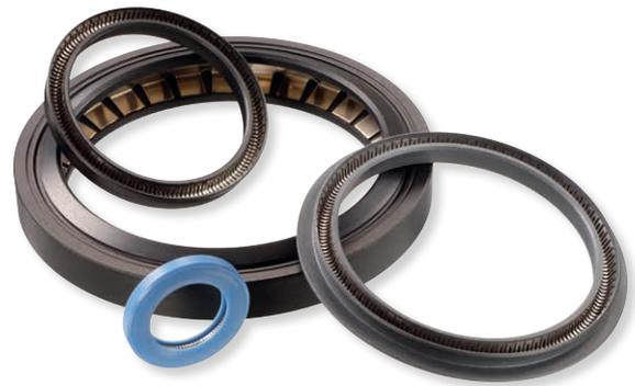
**Nutringe sind einseitig mit Druck beaufschlagbare Dichtungen mit einer universellen Chemikalienbeständigkeit. Sie kommen vor allem im Armaturenbau der allgemeinen Chemie und der Petrochemie zum Einsatz.**
