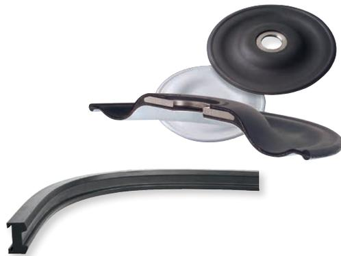
**Membranen aus elastomeren Werkstoffen sind flexible Dichtelemente, die zwei Bauteilräume trennen. Da Membranen dicht, aber zugleich beweglich sind, können die von ihr getrennten Räume Volumenänderungen vollziehen. Drei Grundfunktionen können so erfüllt werden: Regeln bzw. Schalten, Pumpen und Trennen.**
