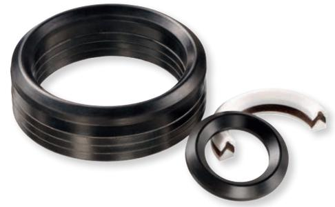
**Dachmanschetten kommen überwiegend bei translatorischen Anwendungen zum Einsatz. Sie weisen eine geringe Reibung und niedrige axiale Vorspannkräfte auf. Dies macht den mehrteiligen Dichtungssatz zu einer geeigneten Alternative zu Packungen.**
