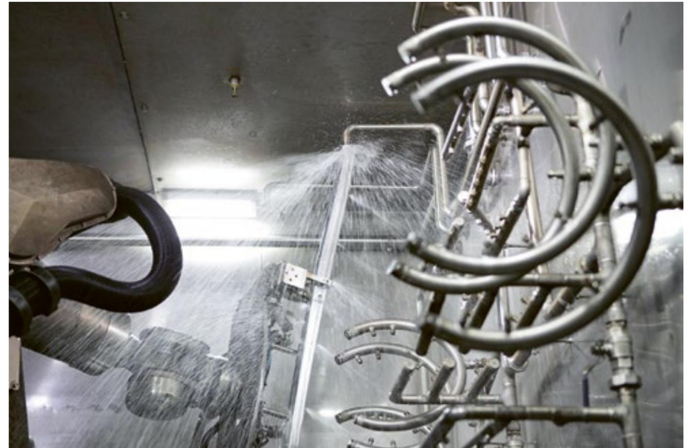
Wasser spritzt von allen Seiten: Der Roboterarm in dieser Waschkammer benötigt Dichtungen, die sein Getriebe vor feinsten Tropfen schützen.
