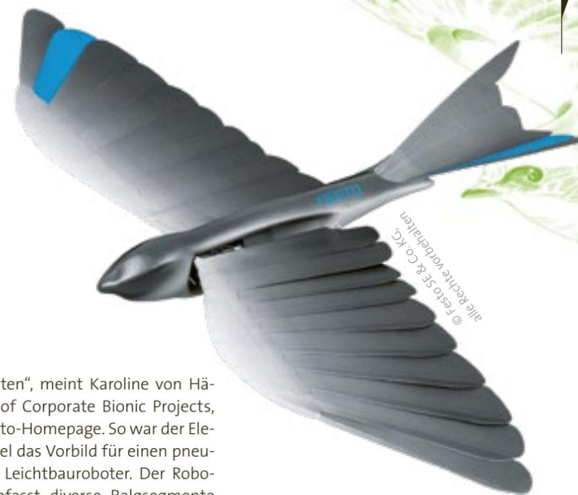
Lamellen aus Schaumstoff, ein Federkiel aus Karbon, ein Motor und jede Menge IT ermöglichen den Flug der Roboterschwalbe.
